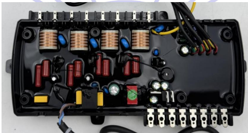
内部结构 (控制器型号: DBD-4FGB, 点火器型号: DBD-G)
